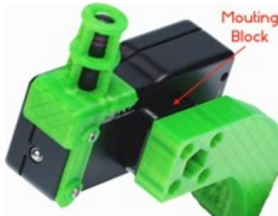
Fixation du support sur le mouting block avec 1 vis CHC 1/4"-20 UNC
