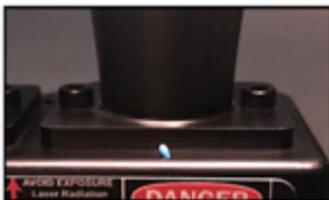
La diode bleue indiquée dans la photo, sous les jumelles est un thermomètre. . Le Focus Bug ajuste son fonctionnement en fonction de la température.
