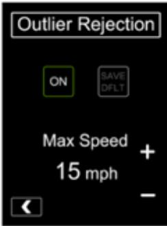
Vous pouvez accéder à ce mode via : SYSTEM SETTINGS -> DSP -> OUTLIER REJECTION. Il permettra au Focus Bug d'ignorer un élément perturbateur passant rapidement devant les jumelles ou une lecture parasite détectée par les jumelles, tout en restant sur le sujet pointé par les jumelles auparavant.
